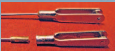
Tipp: Gabelkopf an der Gewindeseite auf 2 mm aufbohren, ein kurzes Stück Messingrohr rein und dort hinein den Stahldraht.
