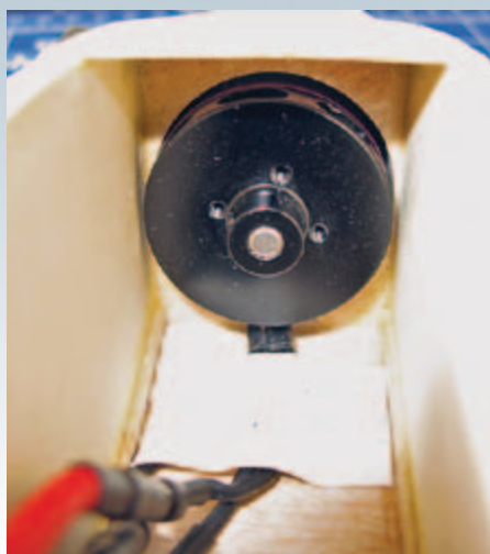
Dieser dicke Brushless-Brummer sorgt für mächtig Vortrieb; die Kabel sind mit Klebeband am Rumpfboden befestigt, damit nichts streift.
